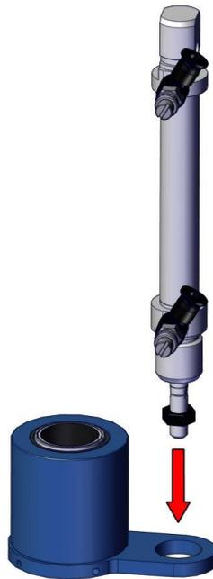
Fissare il cilindro con il dado chiave da 22mm, tenere i raccordi pneumatici allineati lateralmente come in figura.
