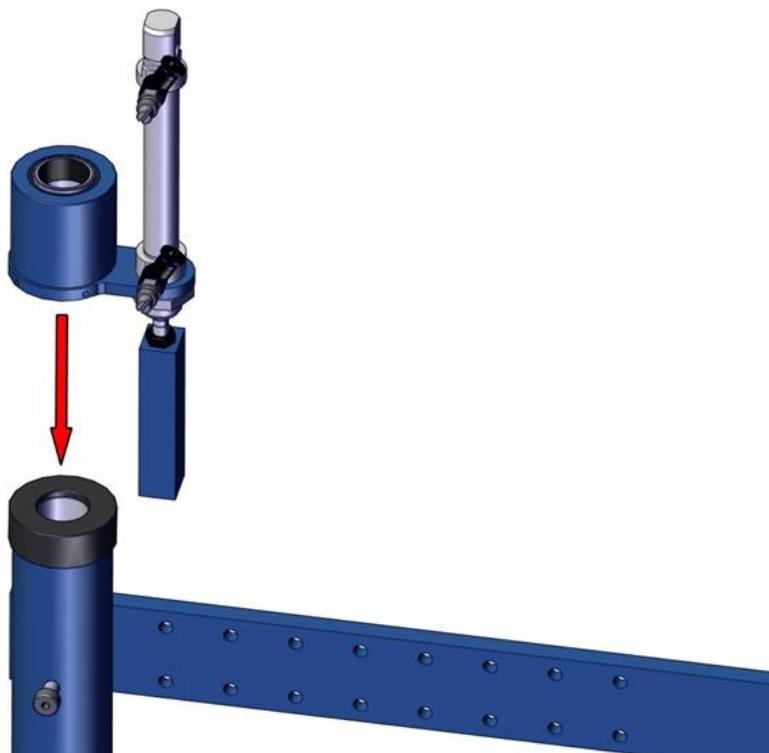
Allineare i fori di fissaggio del supporto del cilindro con i fori della piastra portabraccio. Poi fissare le viti.
