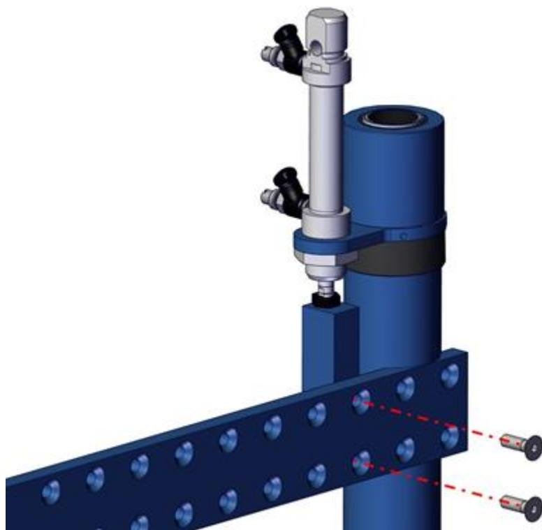
Inserire il kit montato sull'asta di scorrimento.
